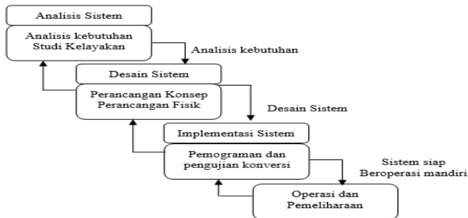
Gambar 2. 1 Siklus Hidup Pengembangan Sistem Model Waterfall
