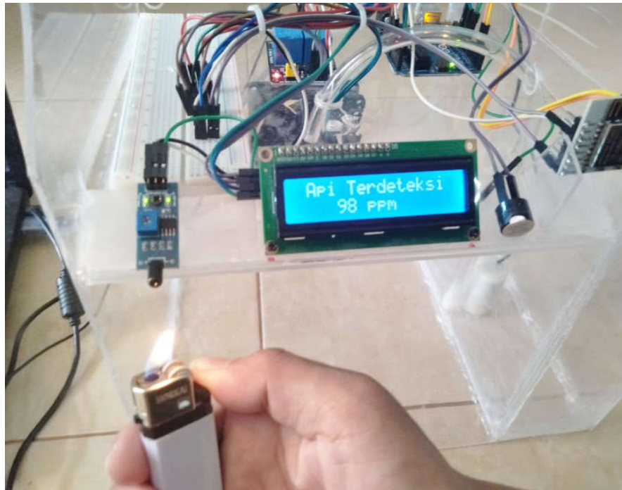
Gambar 5.10 Pengujian Sensor Disaat Terdeteksi Api
