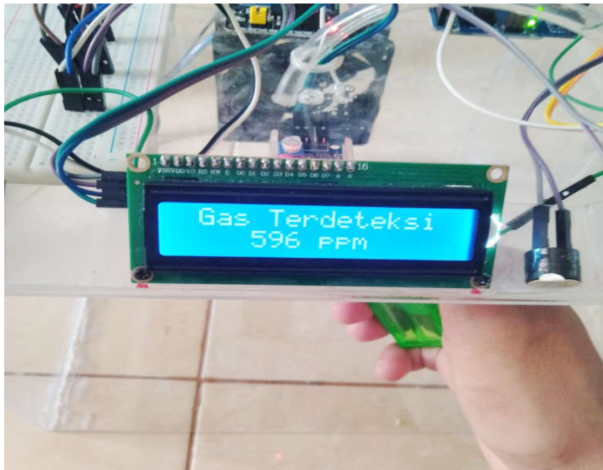
Gambar 5.6 Pengujian Sensor menggunakan korek gas
