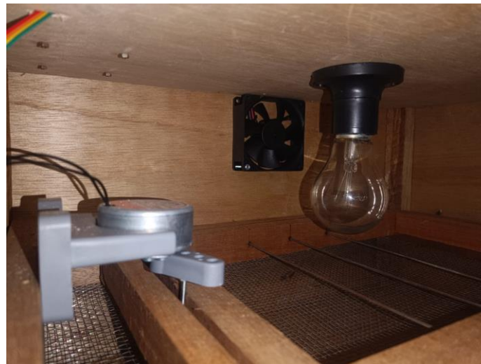
Gambar 5.5 Lampu di mesin tetas
