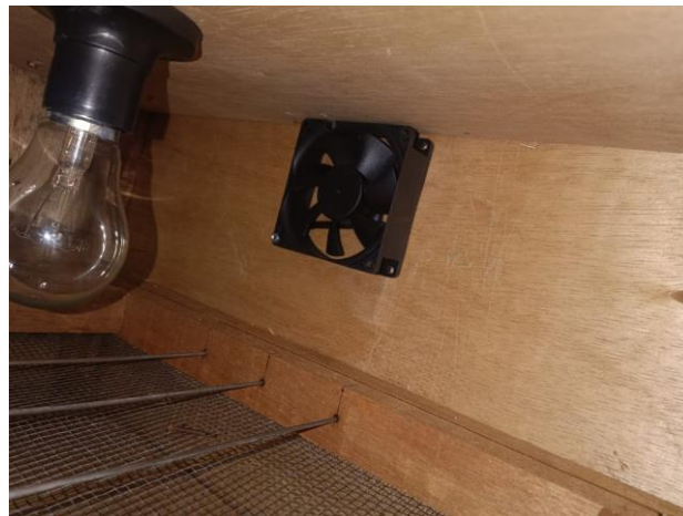
Gambar 5.6 Kipas di mesin tetas
