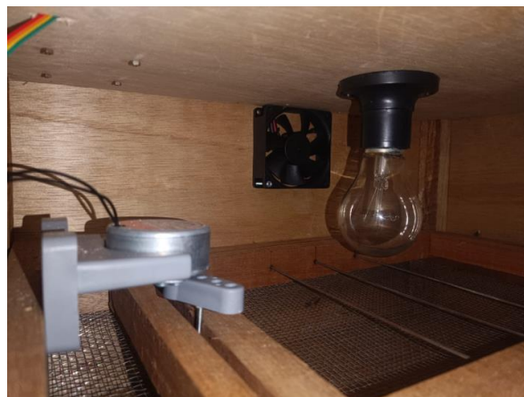
Gambar 5.7 Penggerak di mesin tetas
