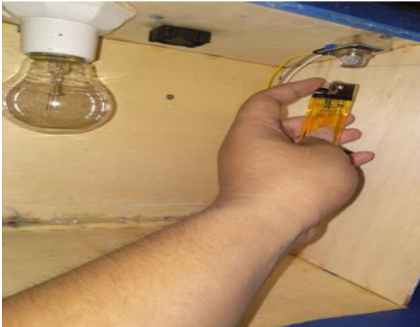
Gambar 5.5 Pengujian Sensor MQ-135 terhadap Korek Gas
