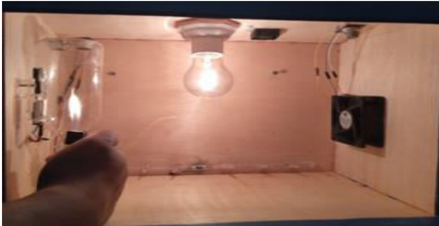
Gambar 5.6 Pengujian Sensor DHT22 Dengan Korek Gas
