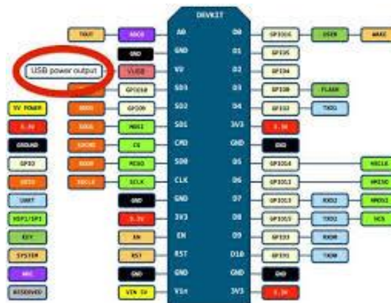
Gambar 2. 9 Skematik Posisi Pin NodeMCU v3
