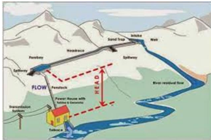
Gambar 2. 2 Komponen PLTMH Sumber : Prayogo (2003)
