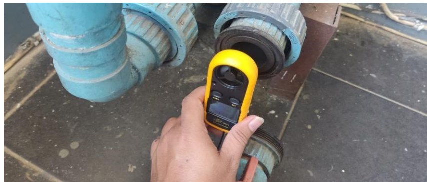
Gambar 4.3 Pengukuran udara yang keluar dari blower dengan anemometer
