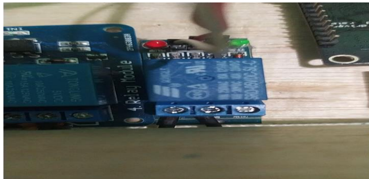
Gambar 5. 5 Pemasangan Kabel Pengontrol Speed Pada Relay
