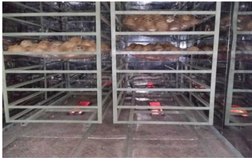
Gambar 2. 4 Jenis Pengeringan Kopra dengan pemanasan tidak langsung
