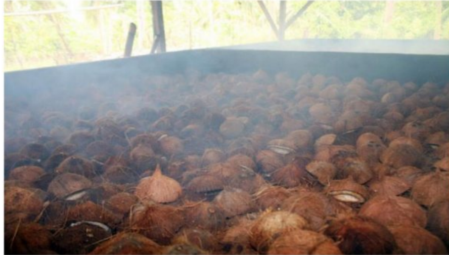
Gambar 2. 3 Jenis Pengeringan Kopra dengan Bara Api Atau Pengasapan
