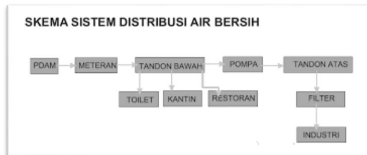
Gambar 5.13 : skema jaringan air bersih
