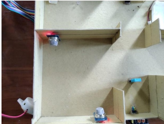
Gambar 4.17 Posisi sensor Gas MQ2 diruang dapur
