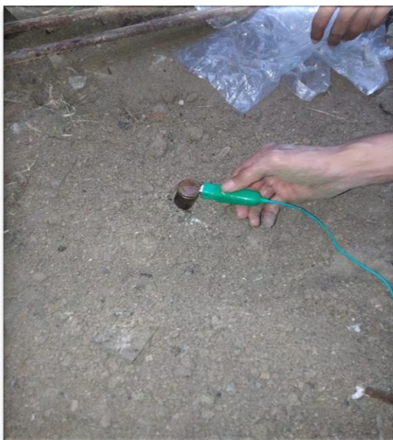
Gambar 20 (Pengukuran 1 Batang Elektroda Pentanahan)
