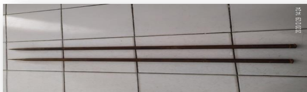
Gambar 9.( Elektroda Batang Pentanahan)
