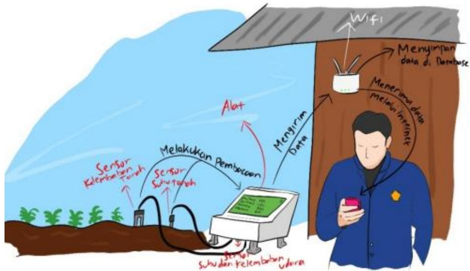
**Gambar 2.7 Ilustrasi Kerja Alat**
