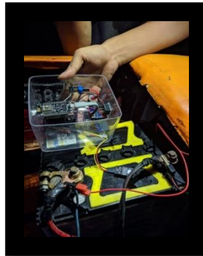
Gambar 4.1 Implementasi Alat (Perangkat Sistem) Monitoring tegangan dan suhu aki
