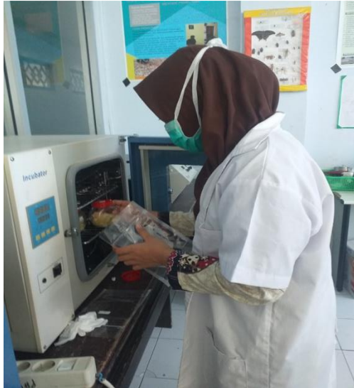
Proses fermentasi daging buah durian yang telah ditambahkan gula selama 7 hari didalam incubator dengan suhu 25°C.
