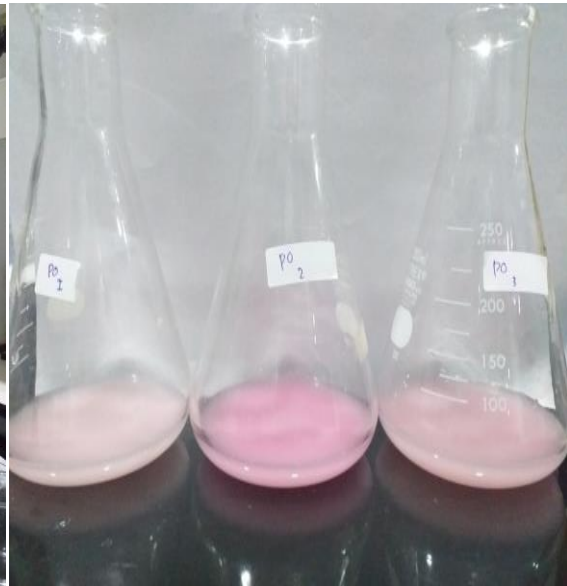
Proses analisis total asam kanas menggunakan metode titrasi
