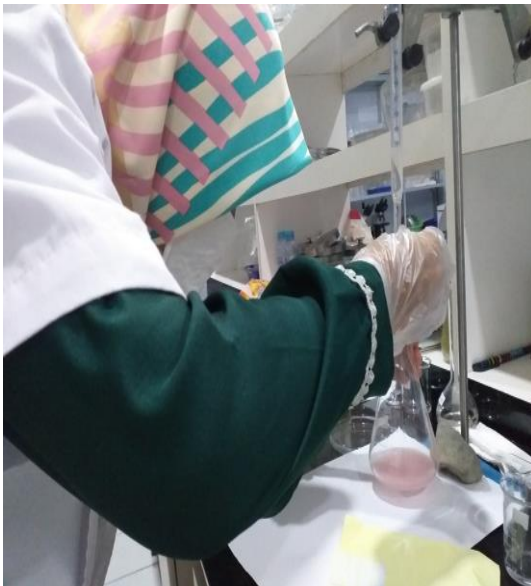
Proses analisis total asam kanas menggunakan metode titrasi
