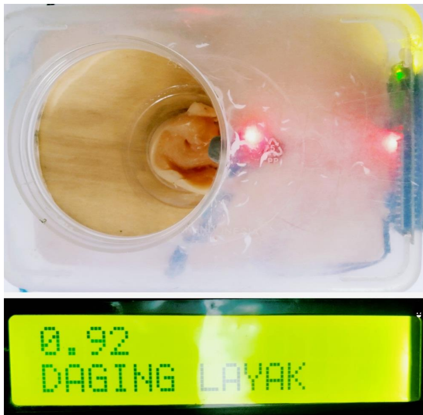
Gambar 5.4 Pengujian Dalam Kondisi Ada daging 1 hari potong
