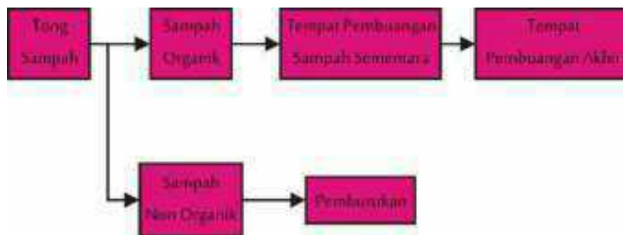
Gambar 5.21 : Skema sistem pembuangan sampah Sumber : Analisa penulis
