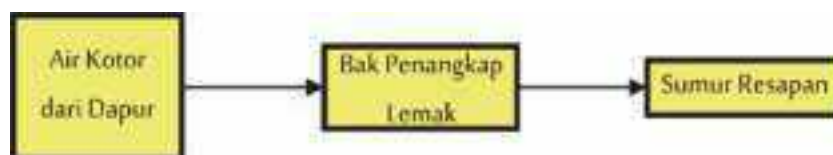
Gambar 5.19: Skema Jaringan air kotor dari dapur
