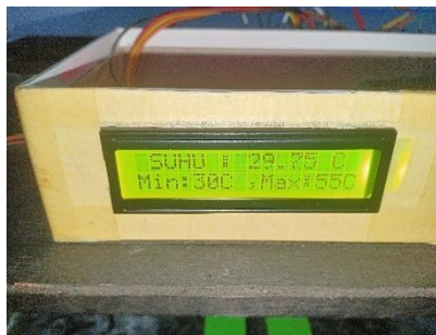
Gambar 4. 3 Tampilan Hasil Pengujian Rangkaian Sensor Suhu dan LCD
