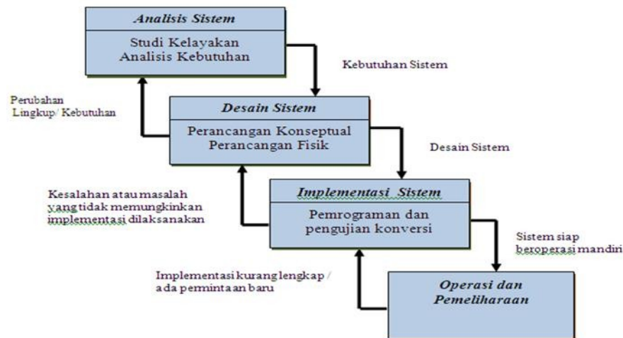
Gambar 2.2: Siklus Hidup Pengembangan Sistem Model Waterfall
