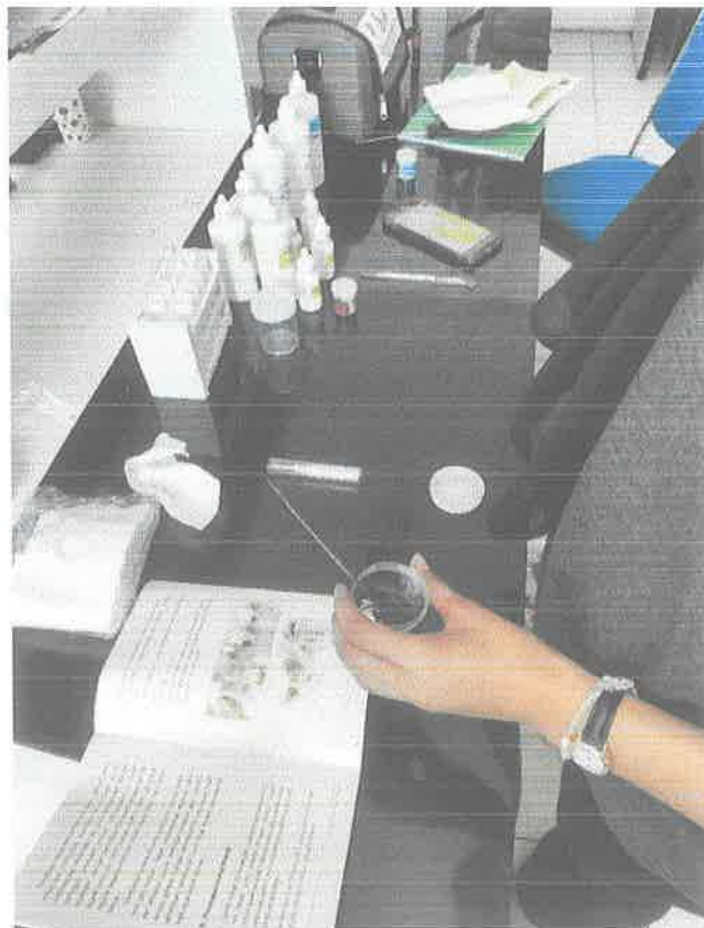
Pengujian sampel tanah menggunakan PUTS
