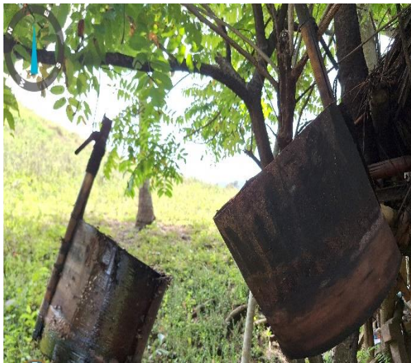
Alat untuk menahan luapan didihan air nira dalam proses memasak
