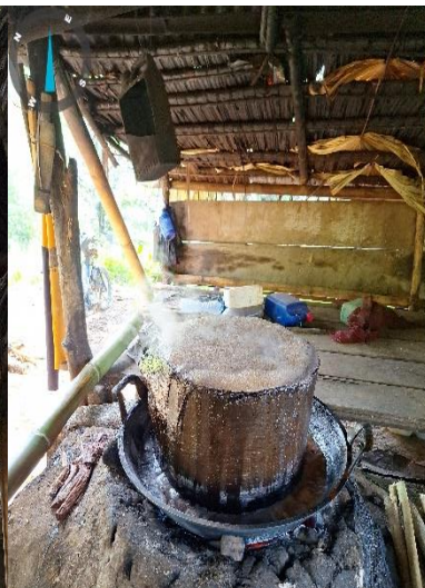
Alat untuk menahan luapan didihan air nira dalam proses memasak
