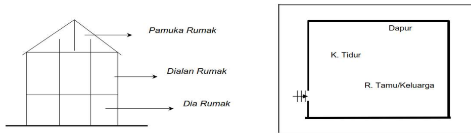
Gambar 2.1. Susunan Vertikal dan Horisontal Rumah Tradisional Suku Bajo Sumber: Jumran, (2010)
