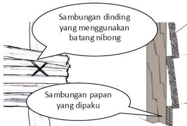
Gambar 2.5. Konstruksi Dinding Rumah Suku Bajo
