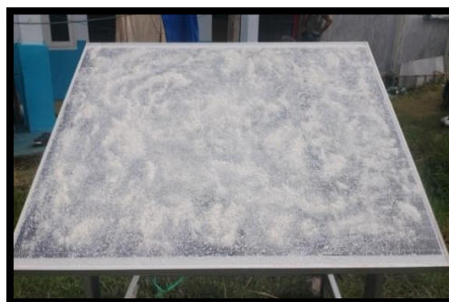
Gambar 4.6 Panel Surya Kondis terpolusi Kering
