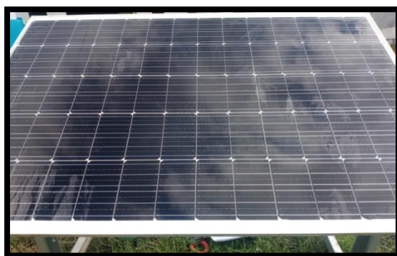
Gambar 4.8 Panel Surya Kondisi Terpolusi Basah
