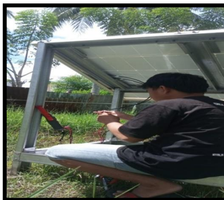
Gambar 3.13 pengukuran tegangan dan arus
