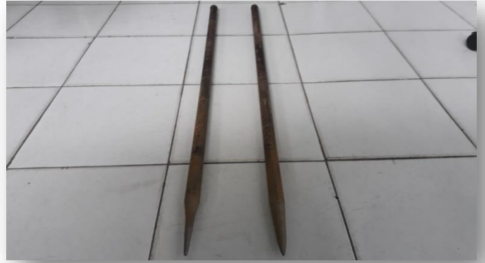
Elektroda tembaga, diameter 2,5 cm Panjang 100 cm
