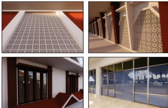
Gambar 3. 11 Bukaan untuk memanfaatkan cahaya matahari dan angin sebagai sumber pencahayaan dan penghawaan alami.
