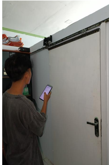
Gambar 4. 15 Tampilan tombol virtual ditekan ( ON ) dalam kondisi pintu tertutup
