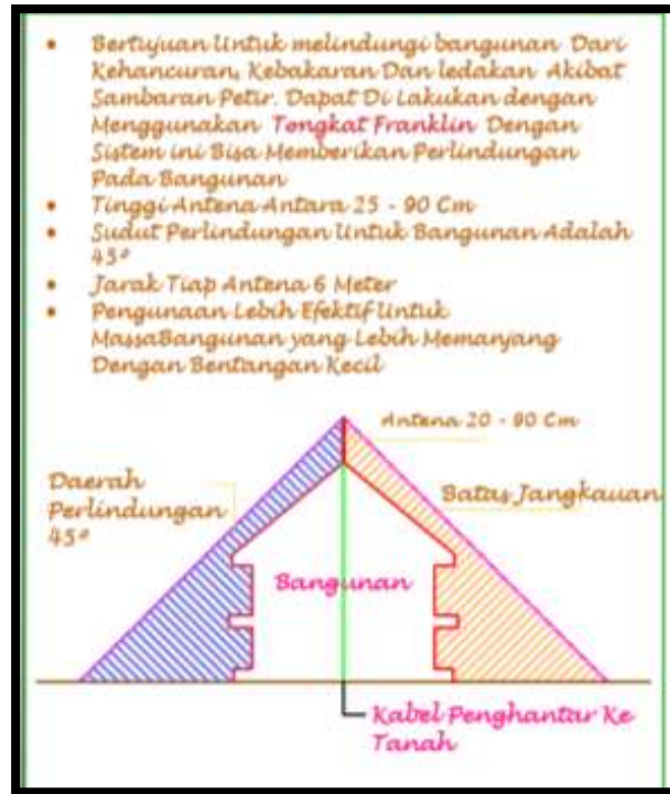
Gambar 5.16. Sistem Penangkal Petir Sumber : Analisa Penulis, 2020
