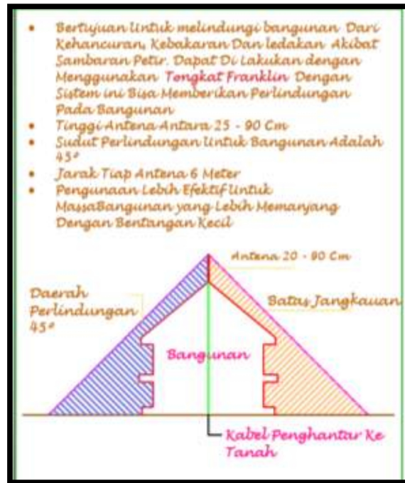
Gambar 5.16. Sistem Penangkal Petir Sumber : Analisa Penulis, 2020
