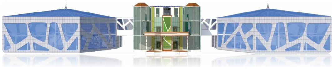
Gambar 5.12. Dinding exterior menggunakan aluminium komposit panel dengan atap plat beton dan atap kaca
