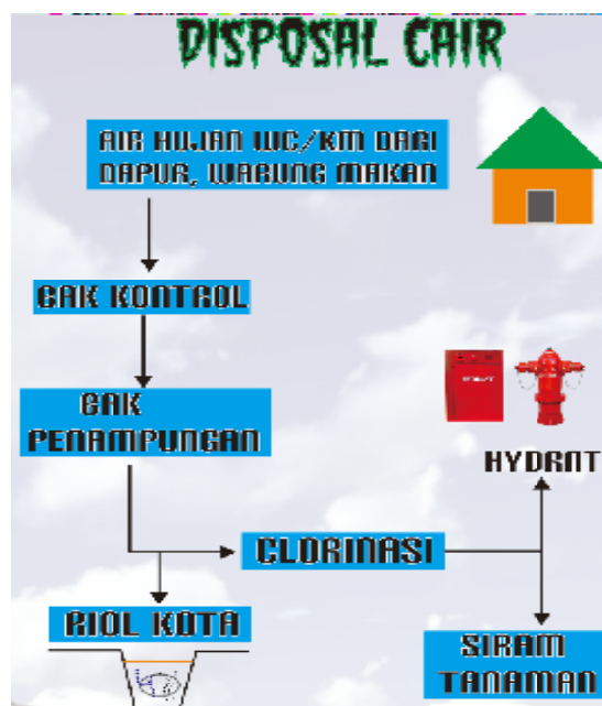
Gambar 5.14 Skema Disposasi Cair Sumber: Analisa Penulis, 2020
