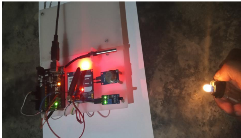
Gambar 5.21: Sensor Mendeteksi Adanya Api
