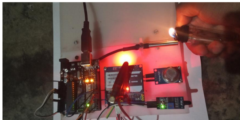
Gambar 5.25 : Sensor Mendeteksi Adanya Perubahan Suhu
