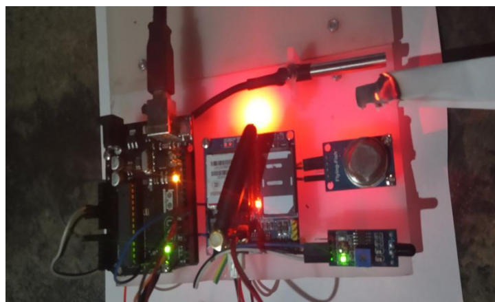
Gambar 5.23 : Sensor Mendeteksi Adanya Asap
