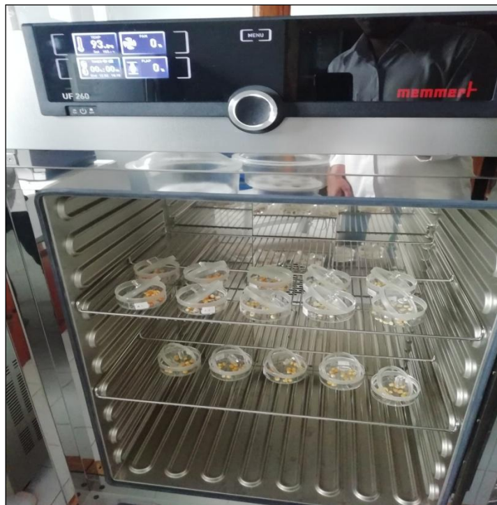
Gambar 4.6 Proses pemanasan sampel dalam oven
