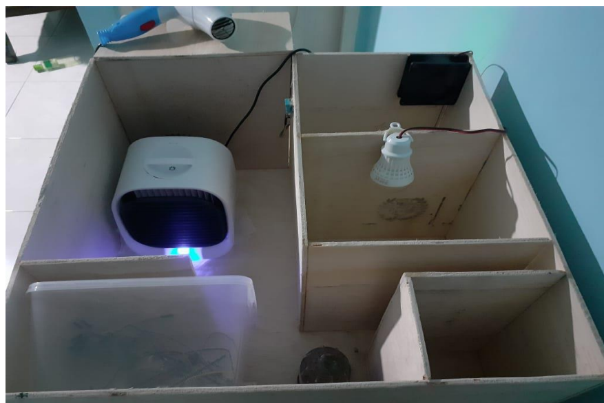
Gambar 5.7 Sensor Suhu dan Kelembaban Setelah Menerima Suhu Dari Hair Dryer
