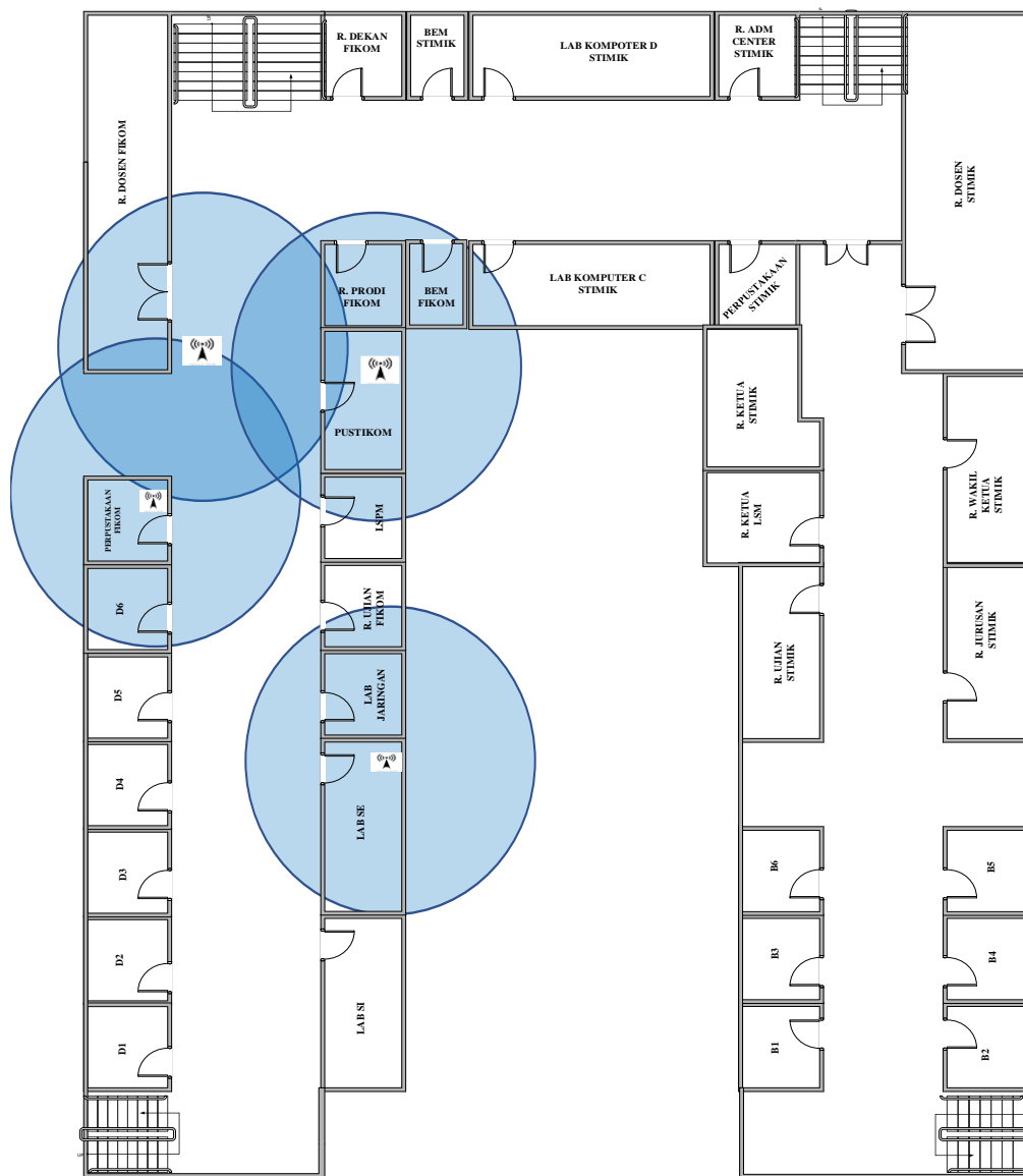
Gambar 4.18 Hasil Survei Interferensi jaringan pada lantai 2
